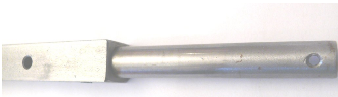
Achse einfach, Achszapfen in Bohrung gesteckt
