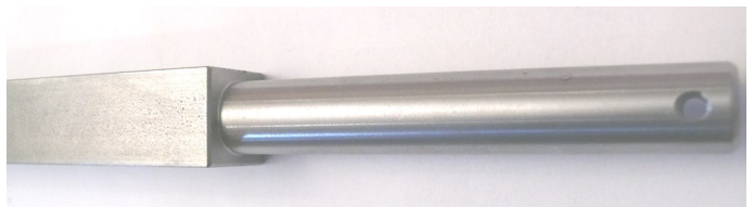
Achse verbessert, Achszapfen angedreht
